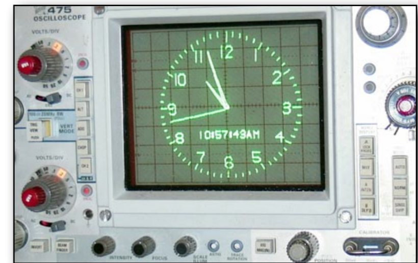
osciloscópio (modo X/Y)
