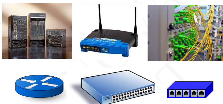
Figura 3.7: Fotografia de vários tipos de comutadores de pacotes de diferentes dimensões e sua interligação através de canais sem fios e de fibras ópticas (figuras superiores). As figuras inferiores apresentam representações convencionadas de comutadores de pacotes através de diagramas.
