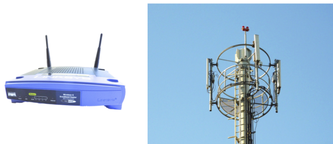
Figura 2.9: Antenas de canais sem fios – Wi-Fi e operador de telecomunicações
