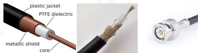
Figura 2.6: Cabo coaxial e ficha de terminação
