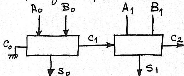
O resultado da operação será  $A+B = C_2 S_2 S_0$ . No entanto o sinal de transporte  $C_1$  só aparece depois de efectuada a soma  $A_0 + B_0$  e  $S_1$  e  $C_2$  só deverão ser considerados após a soma  $C_1 + A_1 + B_1$  ser efectuada. Apesar de portanto haver atraso entre a entrada dos valores e a saída do resultado ou seja  $S_0$  aparece primeiro que  $S_1$ .
