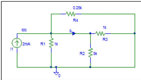
Obtém-se, tendo em atenção que  $R_{eq2} = R4 // R1 = 0.2K\Omega$
