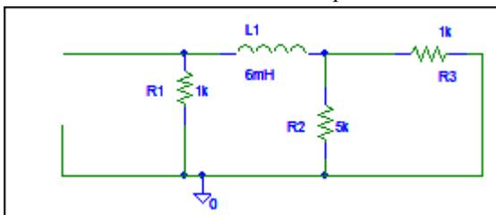
Temos duas hipóteses: Ou analisamos o circuito como está (p.ex. com método de nós), ou substituímos R2//R3 pela resistência equivalente Req=833.3 Ω
