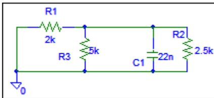
Temos duas hipóteses: Ou analisamos o circuito como está (p.ex. com método de nós), ou substituímos pela resistência equivalente
