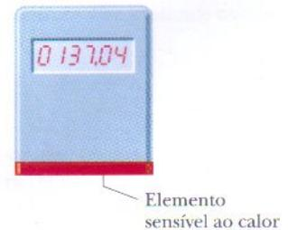
FIG. 18-2 Um termoscópio. Os números aumentam quando o dispositivo é aquecido e diminuem quando é resfriado. O sensor térmico pode ser, entre outras coisas, um fio cuja resistência elétrica é medida e indicada.
