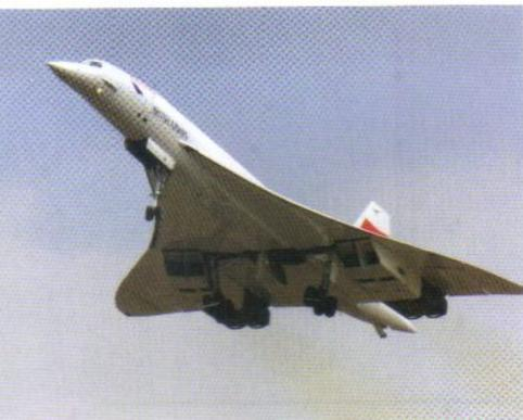
**FIG. 18-9** Quando um Concorde voava mais depressa que a velocidade do som a dilatação térmica produzida pelo atrito com o ar aumentava o comprimento da aeronave em 12,5 cm. (A temperatura aumentava para 128°C no nariz e 90°C na cauda. Era possível sentir com a mão o aquecimento das janelas.) (Hugh Thomas/BWP Media/Getty Images News and Sport Services)
