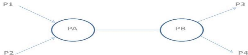
Conforme se indica na figura, os processos P1, P2, P3 e P4 não podem comunicar directamente entre si:
